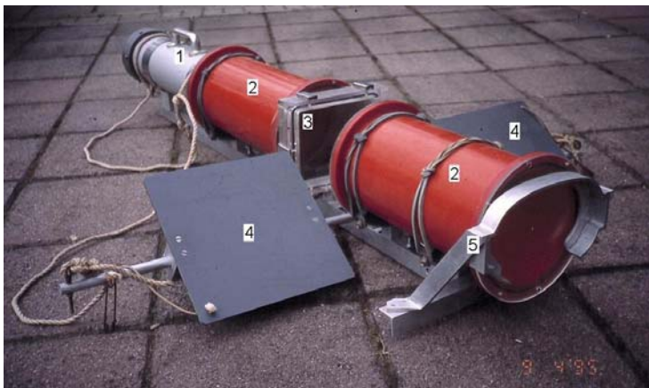
Fig. 9 Contrast-apparaat 1 Halogeen lamp, 2 PVC koker met perspex vensters en gevuld met kraanwater, 3 houder met sinus raster, 4 arm/handsteunen, 5 maskerhouder.
